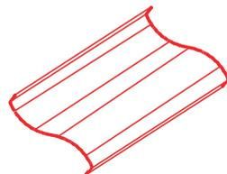
Ламели еврожалюзи — предназначены для изготовления заборов-жалюзи, металлических пергол, беседок, горизонтальных жалюзи на крыше.
